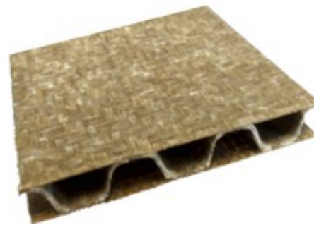
Composites epoxy/lin pour l'aéronautique
