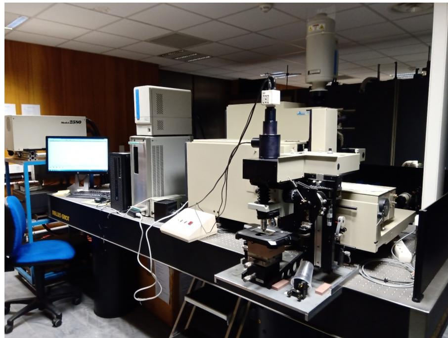
Banc lasers → microscope confocal → triple monochromateur → bloc détecteurs → DAQ → spectre
